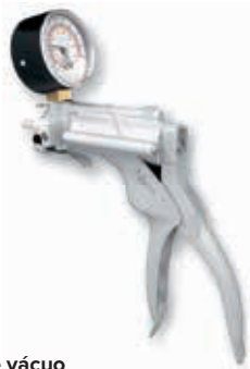
Bomba manual de vácuo Bomba de ar mecânica, simples, para o enchimento e para a evacuação de pequenos recipientes com alça ergonômica, manômetro giratório de 360°, válvula de ventilação, duas mangueiras (longa e curta) e seis adaptadores para a conexão. Manômetro: -980 hPa – 4000 hPa Conexão da mangueira: 8,5 mm Ø Mangueira: 850 mm x 6,5 mm Øinterior 65 mm x 4,5 mm Øinterior Dimensões: aprox. 180x60x260 mm 3 Massa: aprox. 0,3 kg P-1012856
