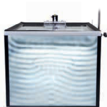
Reflexão de ondas de água num espelho côncavo
