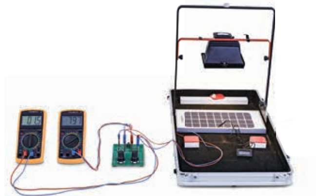
Dependência da temperatura da potência de módulos solares
