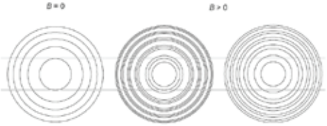
Padrão de interferência do interferômetro (esquerda), dissociação triplet no efeito transversal (meio) e duplet no efeito longitudinal (direita) de Zeeman
