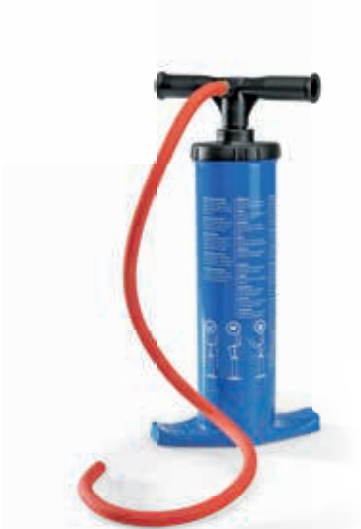
Bomba de vácuo de pistão Robusta bomba de duplo pistão para experiências com vácuo que não requer mais de 400 hPa. Tanto no movimento ascendente como no movimento descendente do êmbolo o ar é aspirado do recipiente. Vara de bombeio com punho para pegar e estribo de pé maciço. Inclui mangueira de vácuo de Ø 5 mm. Pressão final: 400 hPa Conexão da mangueira: 5 mm Ø Dimensões: aprox. 160x235x560 mm 3 Massa: aprox. 1,7 kg P-1000798
