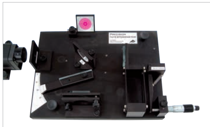
Placa de vidro no feixe de raios do interferômetro de Michelson
