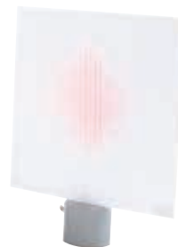
Geração de interferência de dois feixes com bi-prisma de Fresnel
