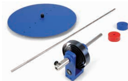
Momento de inércia J dos corpos de massa em dependência do quadrado da distância r das massas
