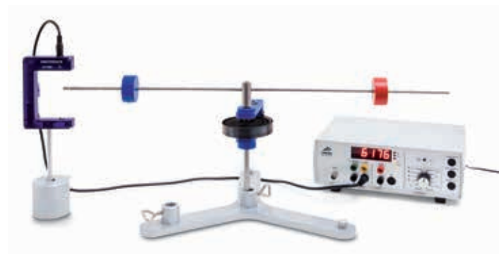
Momento de inércia J dos corpos de massa em dependência do quadrado da distância r das massas
