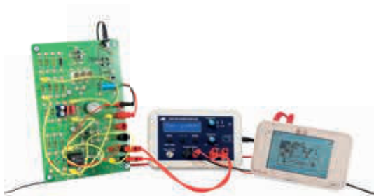
Desenho da curva de ressonância de um circuito em série RLC
