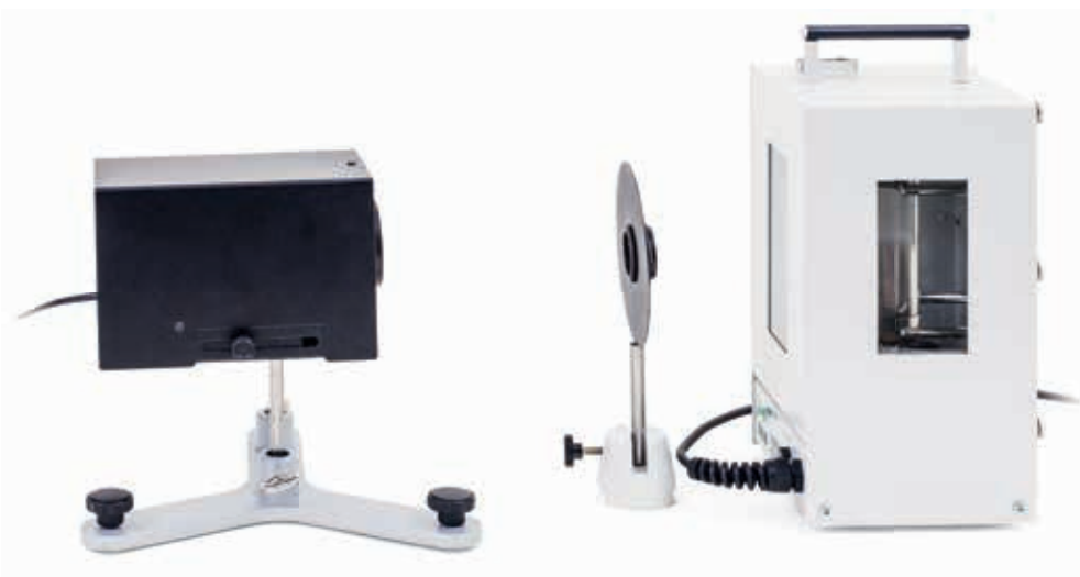
Montagem da experiência para iluminação do tubo de fluorescência de sódio com luz branca focada.
